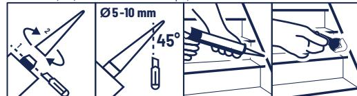
**Important:** Temperatura de aplicare: +5°C până la +40°C. Pentru rezultate optimă pe mase plastice, smirgheluiți suprafețele în prealabil. Nu poate fi vopsit. Nu se utilizează la acvarii. Reziduurile proaspete se curăță cu spirit. Reziduurile uscate se îndepărtează pe cale mecanică. Culoare: Alb - RAL 9010.
